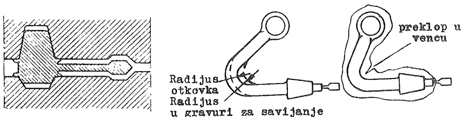
Sl.8 Uticaj radijusa savijanja na stvaranje kovačkog preklopa
